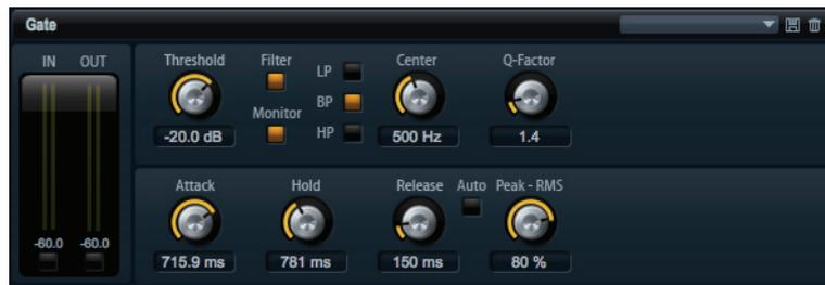
入力サウンドが設定したスレッシュホールドを超えたときのみ、ゲートはサウンドを出力します。スレッシュホールドを下回るサウンドは無音となります。そのかわり、内部のサイドチェーンフィルターでフィルターがかかった入力サウンドを分析できます。この方法で、ゲートは入力サウンドのうちの特定の周波数だけを抽出します。
