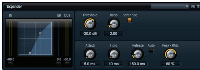
エキスパンダーは、スレッシュホールドを下回る信号に対して、入力レベルに応じた出力レベルの低減を行なうエフェクトです。ダイナミックレンジを増幅したい場合や、静かなパッセージ内のノイズを低減したい場合に便利です。左側のグラフィックコントロールはエキスパンダー曲線を表しています。このコントロールを操作するとスレッシュホールドとレシオを視覚的に編集できます。入/出力 VU メーターは拡大前とあとのレベルを表示します。ゲインリダクションメーターは現在のレベル減衰を表示します。
