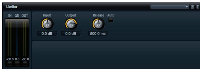
たとえば後ろに続くエフェクトでクリッピングが発生するのを避けるため、サウンドが出力レベルの設定値を超えないようにするエフェクトです。入/出力 VU メーターはリミッター作動前とあとのレベルを表示します。中央のゲインリダクションメーターは現在のレベル減衰を表示します。
