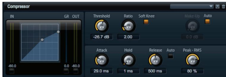
コンプレッサーはサウンドのダイナミックレンジを低減します。これにより、サウンドにヘッドルームが得られます。このヘッドルームを利用してサウンド全体のボリュームをさらに上げることができます。左側のグラフィックコントロールはコンプレッサー曲線を表示しています。このコントロールを操作するとスレッシュホールドとレシオを視覚的に編集できます。入 / 出力 VU メーターは圧縮前とあとのレベルを表示します。ゲインリダクションメーターは現在のレベル減衰を表示します。
