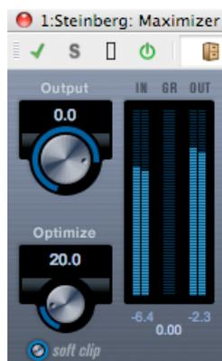
Maximizer は、クリッピングを防ぎながらオーディオ素材のラウドネスを上げるために使用します。また、ソフト クリップ機能により、入力信号の短いピークを削除し、真空管アンプを使用したような暖かい歪みを信号に加えることもできます。
