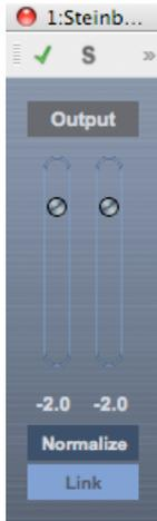
Mix6To2 は、サラウンド ミックス フォーマットをステレオ フォーマットにすばやくミックスダウンできます。最大 6 個のサラウンド チャンネルのレベルを制御し、作成後のミックスに含める各チャンネルの最大レベルを調整できます。
