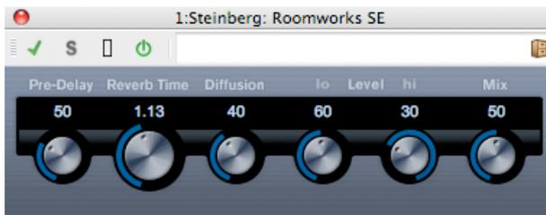
Roomworks SE は、RoomWorks プラグインの簡易版です。このプラグインは、高品質の残響音を作り出せますが、RoomWorks に比べて使用できるパラメーターが少なく、CPU パワーも必要としません。
