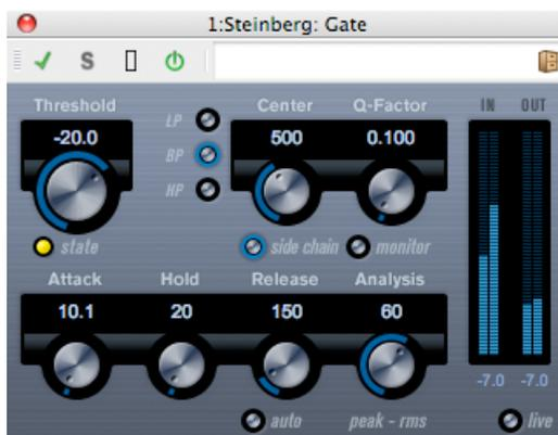
ゲート (またはノイズ ゲート) は、設定したスレッショルド レベルより低いオーディオ信号を無音化します。信号レベルが設定したスレッショルドを超えるとすぐに、ゲートが開いて信号を通過させます。
