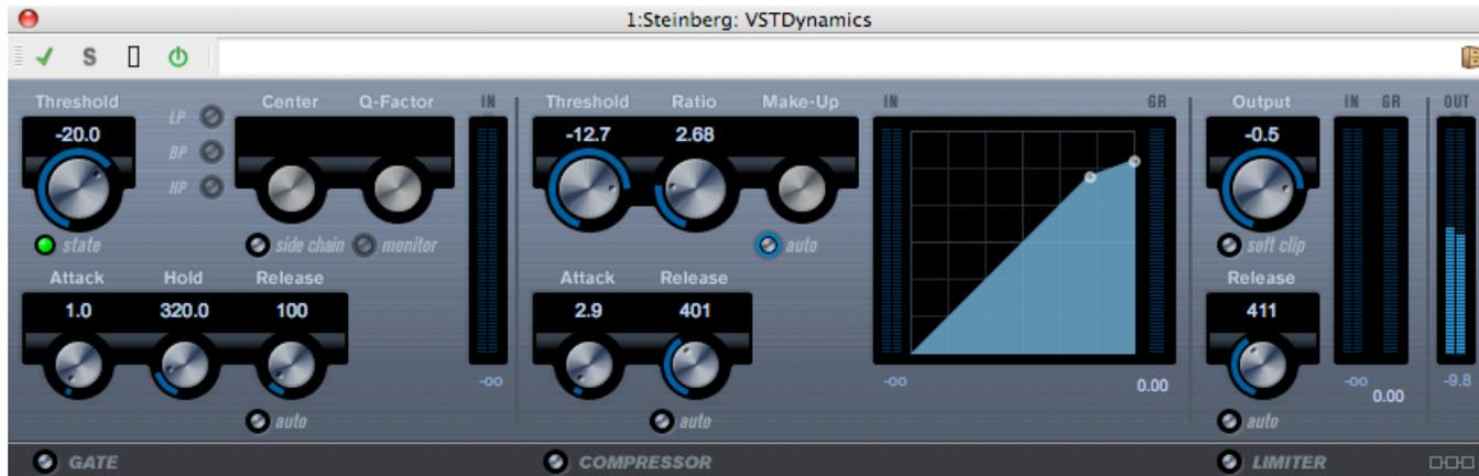
VSTDynamics は高度なダイナミクス プロセッサーです。3 種類のプロセッサー(ゲート、コンプレッサー、リミッター) を組み合わせており、さまざまなダイナミクス処理機能を備えています。ウィンドウは 3 つのセクションに分かれており、各プロセッサー用のコントロールとメーターが表示されます。
