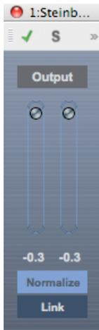
Mix8To2 は、サラウンド ミックス フォーマットをステレオ フォーマットにすばやくミックスダウンできます。最大 8 個のサラウンド チャンネルのレベルを制御し、作成後のミックスに含める各チャンネルの最大レベルを調整できます。
