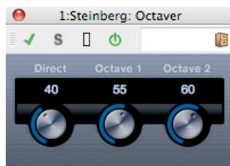
このプラグインは、入力信号のピッチを 1 オクターブ下または 2 オクターブ下でなぞる 2 つの音声を生成し、元の信号に加えることができます。Octaver は単音の信号で使用するのに適しています。
