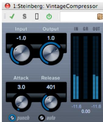
ビンテージ コンプレッサーを再現するプラグインです。入力ゲイン、出力ゲイン、アタック、リリースを個別に制御できます。また、信号のアタック部分を保持する「punch」モードと、プログラムに基づいて「Release」パラメーターを制御する「auto」機能があります。
