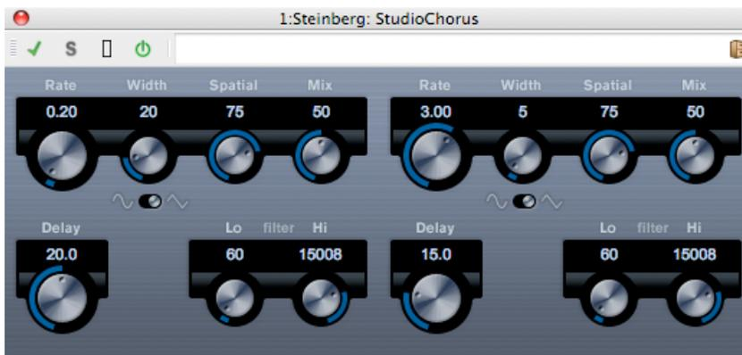
StudioChorus プラグインは、2 段階のコーラス エフェクトです。ショート デイレイを原音に加え、デイレイがかかった信号のピッチを変調することでダブリング エフェクトを作り出します。コーラス変調の 2 つの段階は互いに完全に独立しており、順に処理 (カスケード処理) されます。
