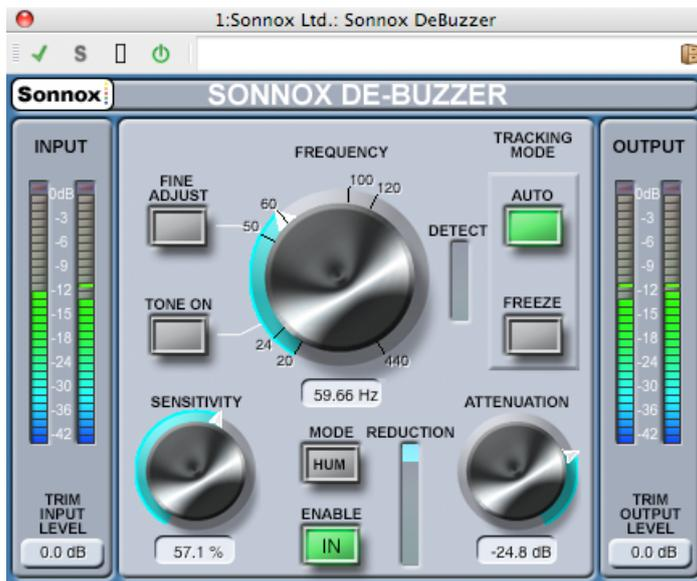
Sonnox DeBuzzer は、Sonnox 社の復元ツールキットを構成する 3 つのプラグインのうちの 1 つです。これらのツールは、古いオーディオ素材を復元するという目的以外にも、新しい録音でも混入することがある、クリック ノイズ (カチツという音)、ポップ ノイズ、バズ ノイズ、バックグラウンド ノイズを取り除くために使用できます。
