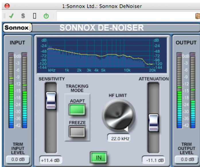
Sonnox DeNoiser は、Sonnox 社の復元ツールキットを構成する 3 つのプラグインのうちの 1 つです。これらのツールは、古いオーディオ素材を復元するという目的以外にも、新しい録音でも混入することがある、クリック ノイズ (カチツという音)、ポップ ノイズ、バズ ノイズ、バックグラウンド ノイズを取り除くために使用できます。
