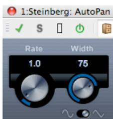
シンプルなオートパン エフェクトです。手動でモジュレーション速度を設定し、異なる波形を指定して左右のステレオ位置をゆらす (パンする) ことができます。
