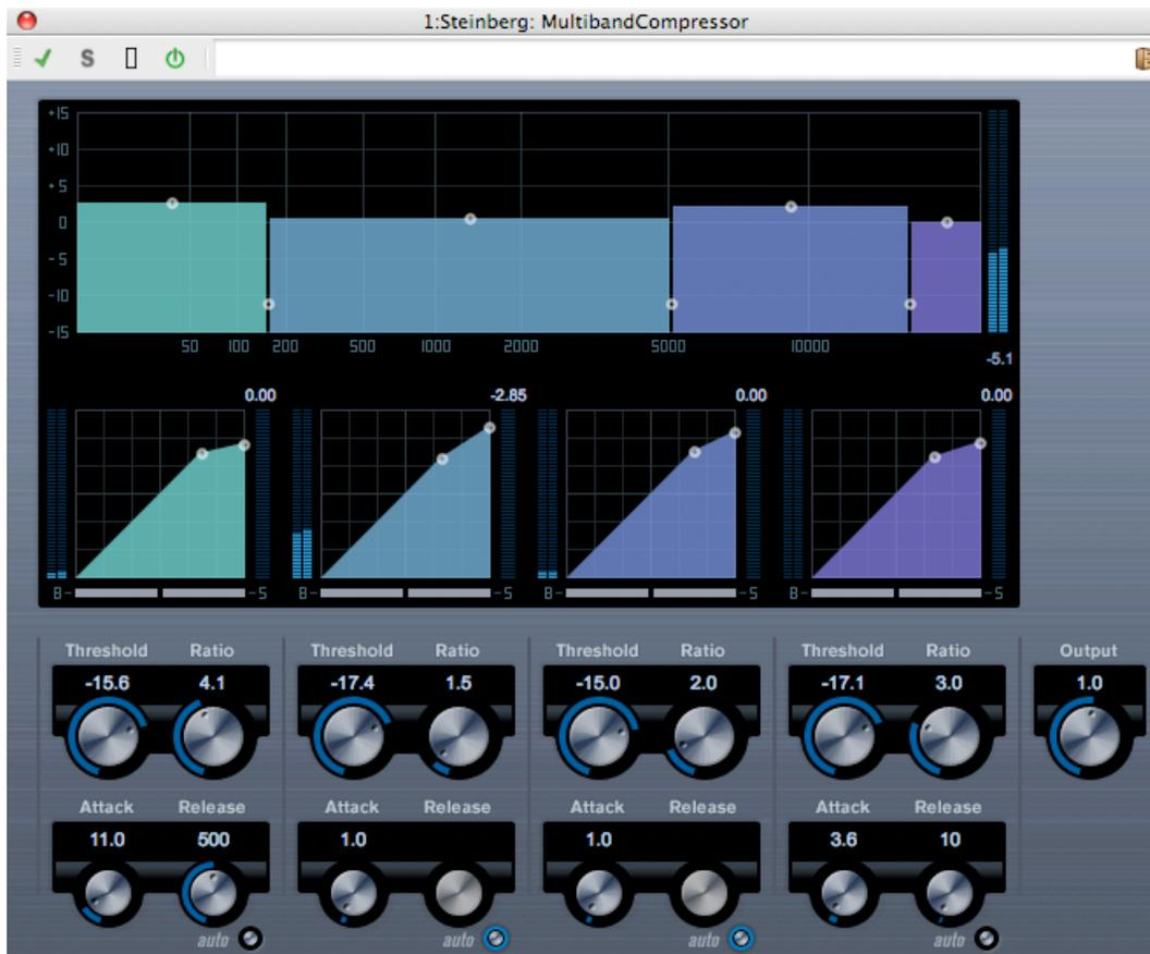
MultibandCompressor は、それぞれ自由にコンプレッサー特性を調整可能な最大 4 つの周波数帯域に信号を分割できます。信号は、周波数帯域セクションとコンプレッサー セクションの設定に基づいて処理されます。それぞれの周波数帯域で、さまざまなコントロールを使用して、レベル、周波数帯域幅、およびコンプレッサー特性を指定できます。
