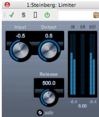
Limiter は、出力レベルを設定レベル以下に抑えて、後続のデバイスでクリッピングが起きないようにすることを目的としています。Limiter は、オーディオ素材に基づいて「Release」パラメーターを自動的に調整し、最適化できます。あるいは、このパラメーターを手動で設定することもできます。また、Limiter には入力、出力、および制限の量を個々に設定するためのメーターがあります (中央の各メーター)。
