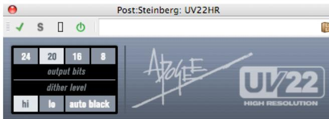
UV22HR は、Apogee 社が開発した高度なアルゴリズムに基づいた、高品質のディザリングプラグインです。このプラグインは、音響情報を一切失うことなく、CD、MP3、AAC などの標準的なメディアに拡張情報（32 ビット浮動小数点数から 24 ビット整数オーディオ）をエンコードできます。事前の試聴や設定は必要なく、オーディオのディテールを最大 30dB までノイズフロアに保持できます。
