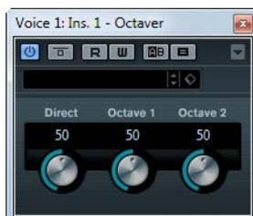
このプラグインは入力信号に対して、2つのボイス (元のピッチに対して1オクターブ下と2オクターブ下)を追加します。Octaverはモノフォニック (単音)の素材に対して最も効果があります。
