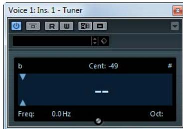
ギター用チューナーです。ギターもしくは他の楽器にインサートエフェクトとして Tuner を選択してください (ピッチエフェクト系のコーラスやビブラートが使用されていないことをご確認ください)。
