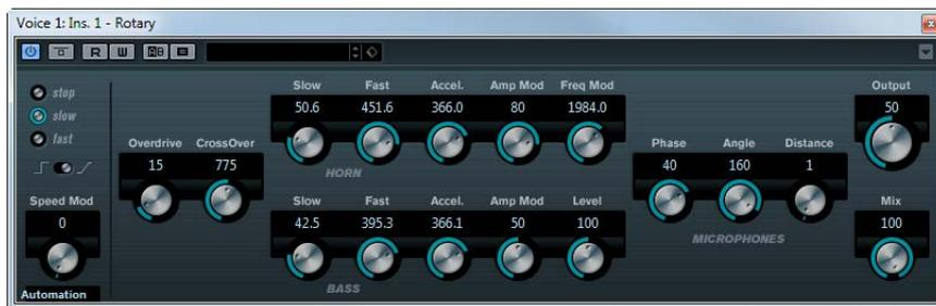
Rotary は、古典的なロータリースピーカー効果をシミュレートするプラグインです。ロータリースピーカーキャビネットは、さまざまなスピードでスピーカーを回転させることで渦を巻くようなコーラスエフェクトを作り出すもので、一般的にはオルガンで使用されています。Rotary のパラメーターは、本物に基づいた特長を持っています。
