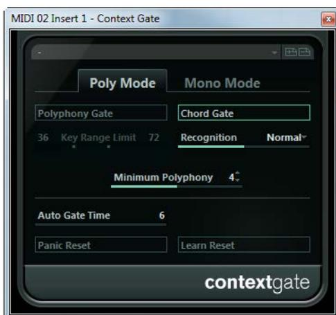
Context Gate は MIDI データをトリガー / フィルターするためのプラグインです。2つのモードによって動作します。「ポリモード (Poly Mode)」の場合、Context Gate は再生された特定のコードを認識しますが、「モノモード (Mono Mode)」の場合、Context Gate は特定の MIDI ノートのみを通過させます。これらのモードにより、MIDI デバイスを設定に応じてコントロールすることが可能です。ライブなどで非常に便利な場面もあるでしょう。
