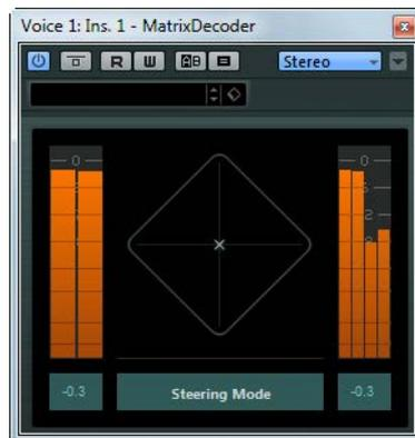
MatrixDecoder では、MatrixEncoder とは逆のプロセスを行いません。つまり、エンコードしたミックスが、プロロジック対応システムでプレイバックされたときに、どのように聴こえるかをモニターするのに使います。エンコードしたミックスが、デコーダーを介してプレイバックされる時、Lt/Rt の両チャンネルから、再び 4 つの出力 (LRCS) に変換されます。
