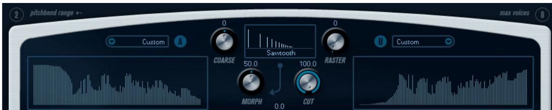
音作りのスタートとして、コームフィルターへ入力されるインパルスを設定します。インパルスコントロールの2つの基本波形は、基本周波数を調節できる独立したスペクトラムフィルターを経由してフィルタリングされます。アウトプットでは2種類の波形/スペクトラムフィルターのミックス量を調節できます。
