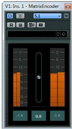
MatrixEncoder は、マルチチャンネルオーディオのプロロジック対応エンコーディングを想定した機能です。これは、4チャンネルサラウンドミックスを、たとえば、放送やビデオによる配給のために、ステレオ 2チャンネルのオーディオまたは 2チャンネルの DVD にまとめるプロセスです。MatrixEncoder は、左、右、中央、サラウンドの 4つの独立した各入力 (LRCS) を受け取り、左トータルと右トータル (Lt と Rt) という 2つの最終出力を作ります。
