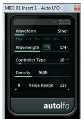
このエフェクトプラグインは、シンセサイザーの LFO と同じように機能し、MIDI コントロールメッセージを、連続的に変化させながら出力できます。典型的な使い方は、自動 MIDI パンニング (コントロール #=10 を使用) ですが、どのタイプの MIDI コントロールイベントでも、選択して使用できます。使用可能なパラメーターを以下に示します。
