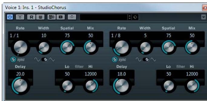
StudioChorus プラグインは 2 段階のコーラスエフェクトで構成されています。信号に短いディレイを付加し、ディレイ信号にピッチモジュレーションを適用してダブリング効果を生成します。コーラスモジュレーションの 2 つの段階はそれぞれ完全に独立したものであり、シリアルに (カスケード) 処理されます。
