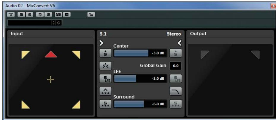
MixConvert V6 プラグインを使用すると、マルチチャンネルミックスを異なるチャンネル構成の形式に素早く変換できます。たとえば、7.1 シネマサラウンドから 5.1 ホームシアターへのミックスダウンなどができます。
