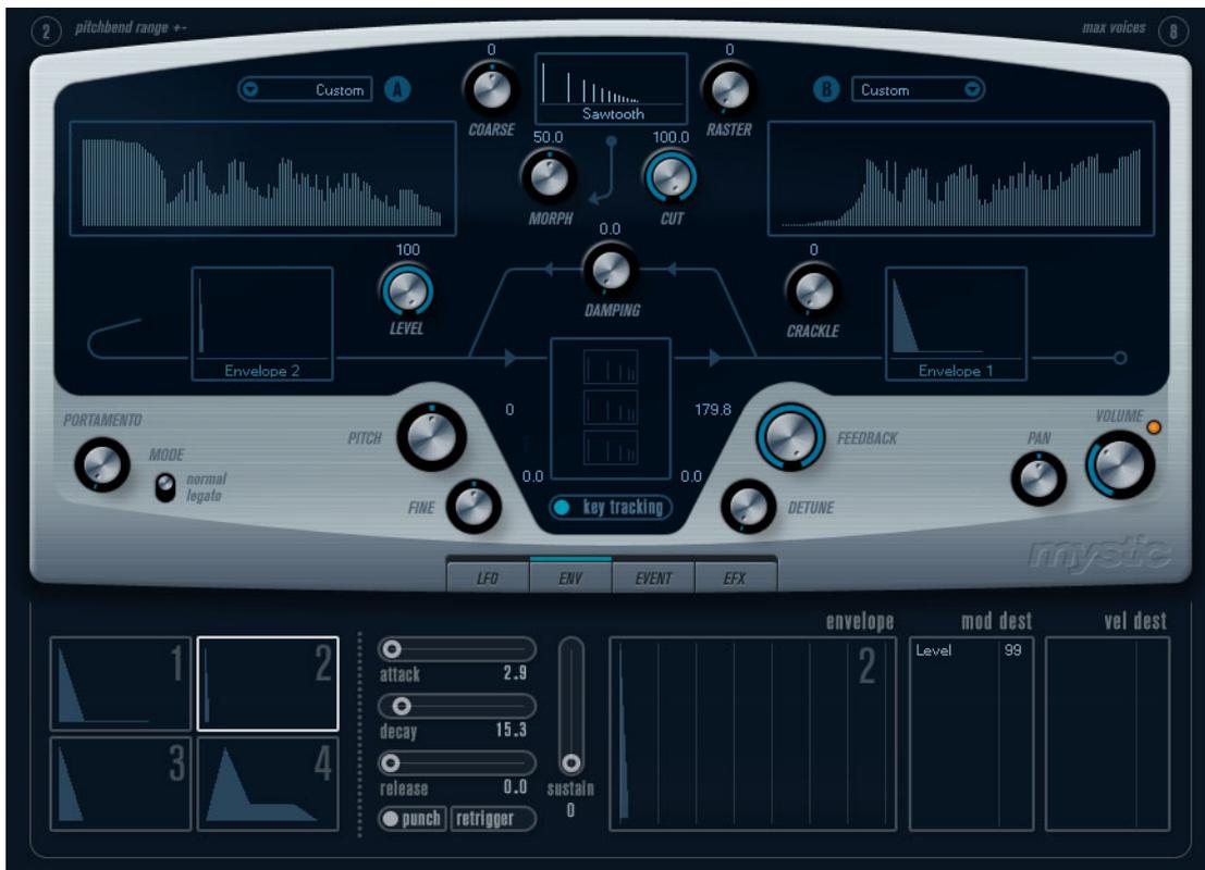
Mysticは3基の並列したコームフィルター（フィードバック付）を搭載したVSTインストゥルメントです。コームフィルターとは周波数特性の中に多くのノッチ（切れ込んだ谷のような部分）があるフィルターを指し、基準のノッチ（最も周波数の低いところにできたノッチ）とその倍音上で生成されるノッチを含んでいます。
