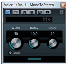
モノ信号を擬似ステレオに変換します。モノ素材をステレオトラックで使用しなければならない場合にインサートエフェクトとして使用します。
