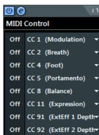
この標準的コントロールパネルでは、8 つまでの異なる MIDI コントロールタイプを選択し、その値を数値またはスライダー ( 数値入力欄を [Alt]/[Option]/[option] キーを押しながらクリックすると表示されます ) で設定できます。多くの場合、MIDI コントロールデータ ( フィルターカットオフ、レゾナンス、レベルなど ) によってコントロールされるパラメーターを備えた MIDI 音源と共に使用します。適切な MIDI コントロールタイプを選択することで、ホストアプリケーションから MIDI 音源のサウンドを調整するためのコントロールパネルとして、このエフェクトプラグインを使用できます。
