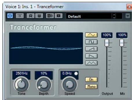
Tranceformer は、リングモジュレーターのエフェクトです。受信したオーディオに、内蔵の可変周波数オシレーターを用いてリングモジュレーションを適用し、新たなハーモニクスを作成します。第 2 オシレーターで第 1 オシレーターの周波数を変調させることもできます。必要に応じ、プロジェクトテンポにも同期します。
